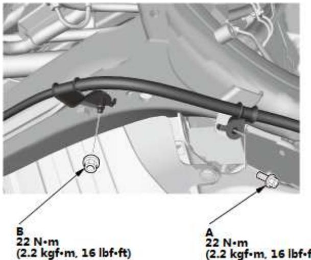
1. 拆下驻车制动器拉线安装螺栓 (A) 和螺母 (B)。
